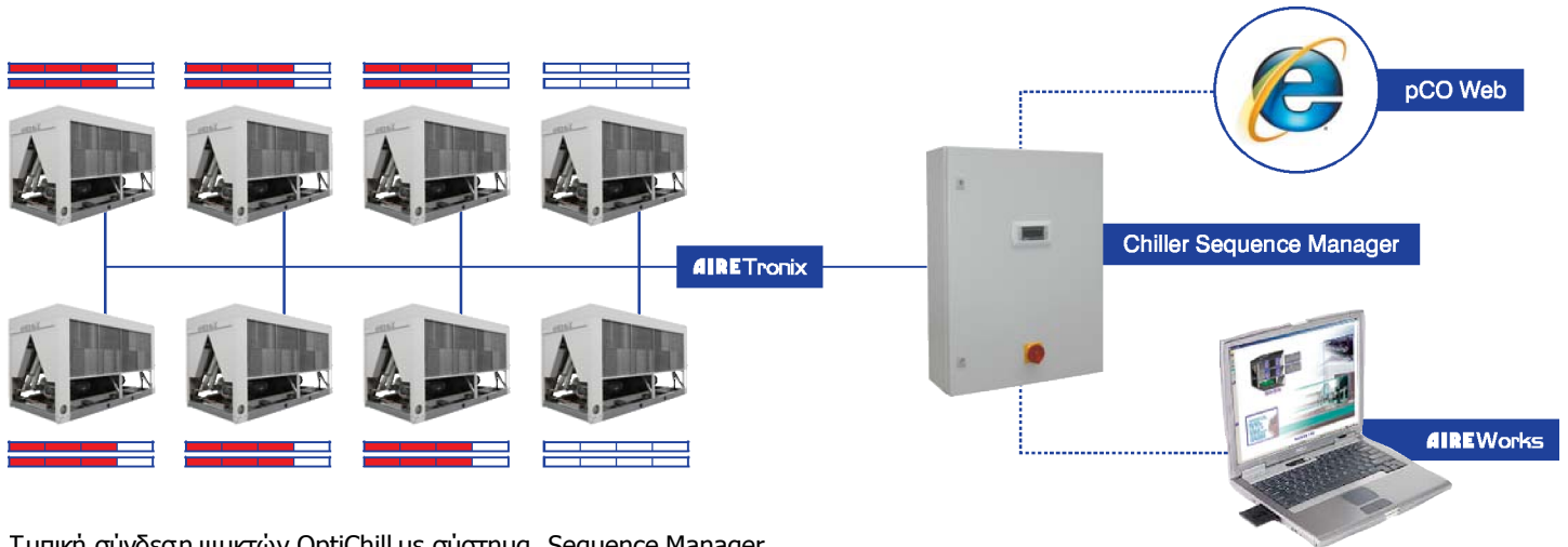
Τυπική σύνδεση ψυκτών OptiChill με σύστημα Sequence Manager
